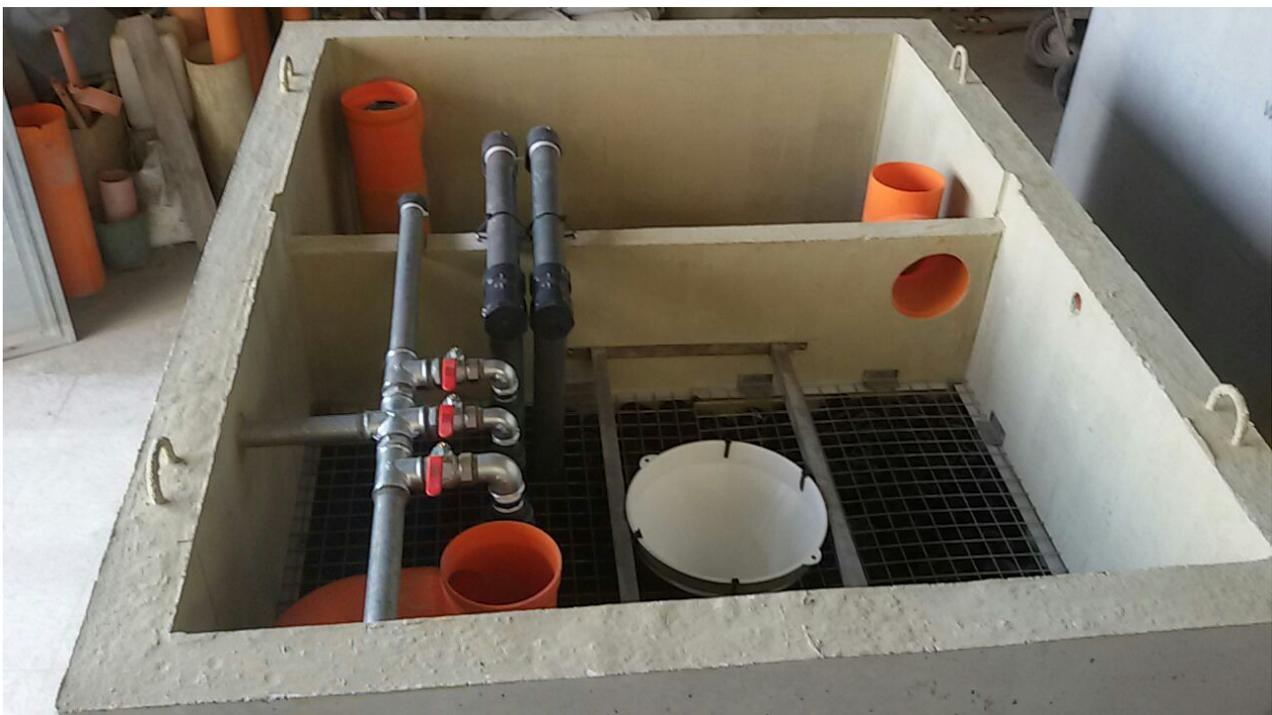
**Fig. 3 - ossigenazione con diffusori (o in alternativa con sistema Venturi)**
